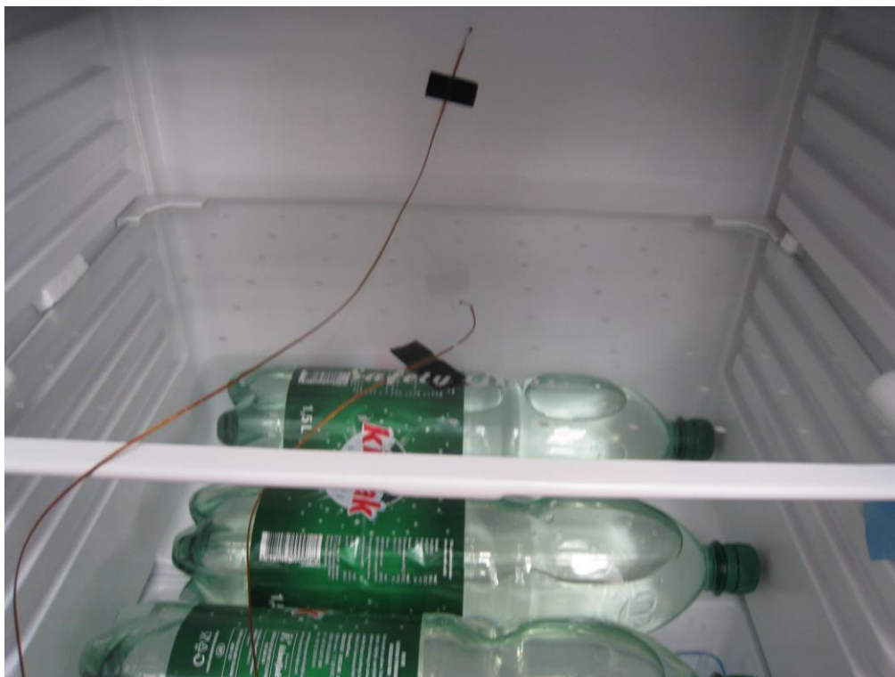
Termoparovi u unutrašnjosti hladnjaka
