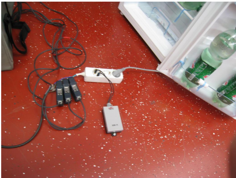
Mjerenje potrošnje sa spojenom jedinicom za uštedu energije
